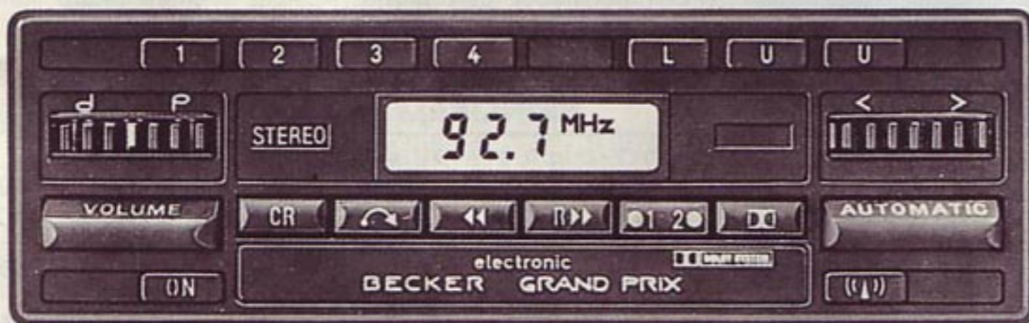
Le Grand Prix offre 16 présélections, dont 8 en FM, mais il n'est pas prévu pour les OC. Son lecteur de cassettes autoreverse et à embrayage magnétique est celui du Mexico.
